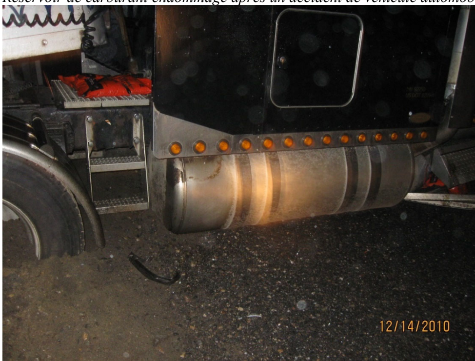
Réservoir de carburant endommagé après un accident de véhicule automobile
