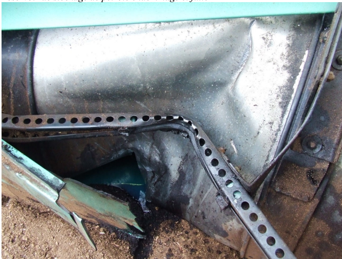
Réservoir de carburant endommagé après un accident de véhicule automobile
